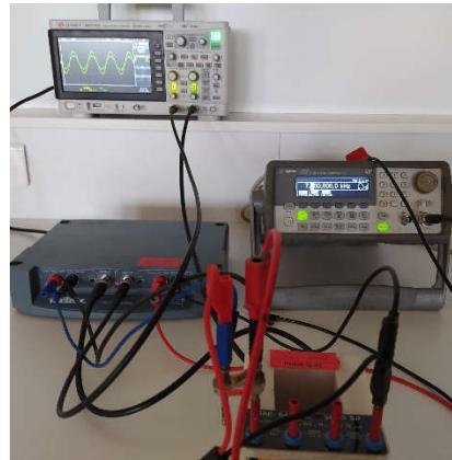
7,8kHzn courant et tension sont en phase, on bascule d'un comportement inductif à un comportement capacitif
